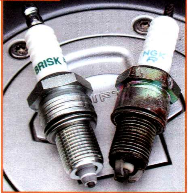
Links die Brisk DR15ZC Gleitfunkenkerze, rechts eine NGK-Kerze mit drei Masseelektroden.
