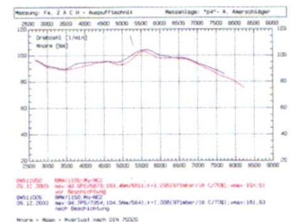
Ebenso deutlich stieg die Drehmomentkurve der 1150 GS, die wir auf dem Prüfstand hatten
